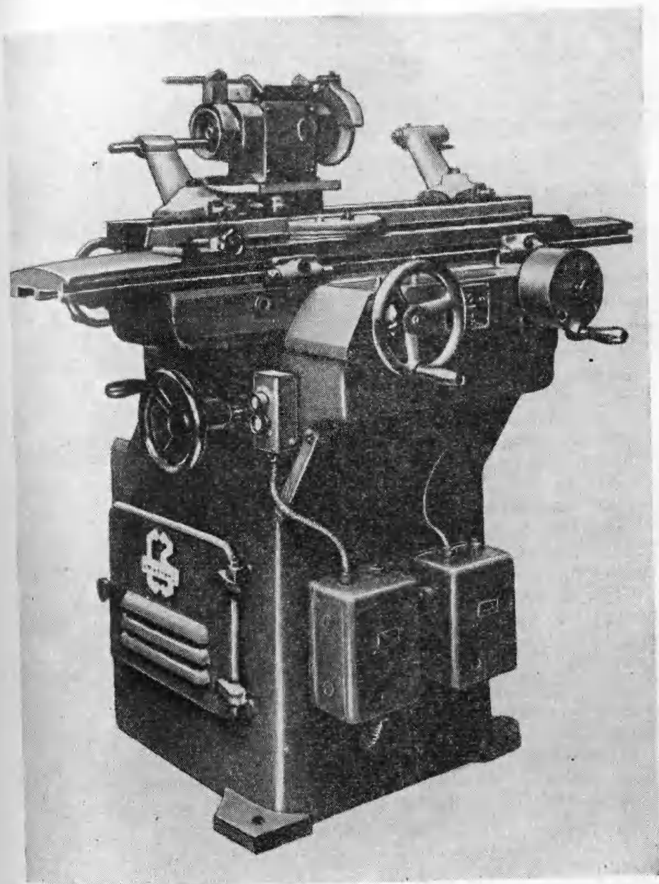
Фиг. 151. Универсально-заточной станок мод. 3А64. Высота центров 125 мм, расстояние между центрами 650 мм (завод имени Ильича в Ленинграде).
