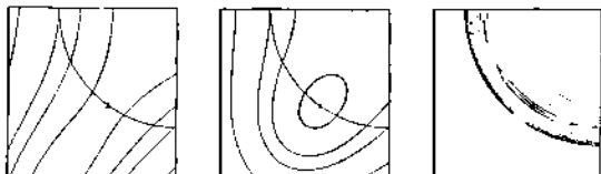
Рис. 6i. Линии уровня модифицированных функций Лагранжа L_d(x, \lambda, \rho) с \rho = 0.075 , \rho = 0.2 и \rho = 100 для значений из примера 6.2 с ограничением, трактуемым как равенство.
