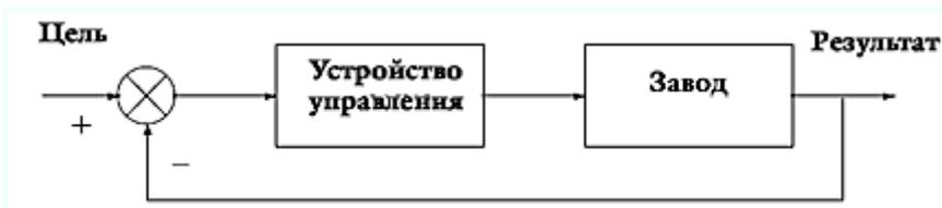
Рис. 6.1. Механизм управления.
