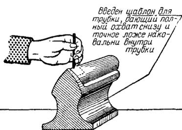
Введен шаблон для трубки, дающий полный ход снизу и точное ложе накопальни внутри трубки
